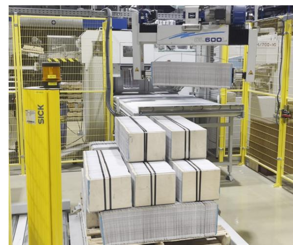
▶ Unsere Palettierroboter sind vielseitig und zuverlässig. Sie palettieren lose und unreife Pakete sowie Stangen, die z. B. vom Stangenstapler SH/700-IG kommen. Die Stangen werden vom Auslagetisch aufgenommen und nach flexiblen Mustern sicher auf der Palette platziert – entweder gleich ausgerichtet oder kreuzweise, um mehr Stabilität zu schaffen. Das Palettenhandling ist vollautomatisch und sorgt für einen effizienten Ablauf.
